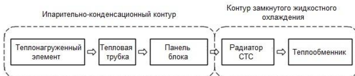
Рис. 1. Структурная схема отвода тепла двухконтурной СТС бортовой АФАР
