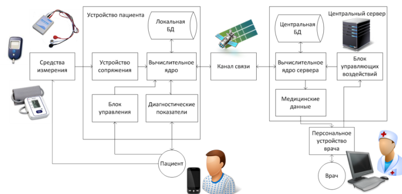
Рис. 2. - Общая структура мобильной телемедицинской системы
