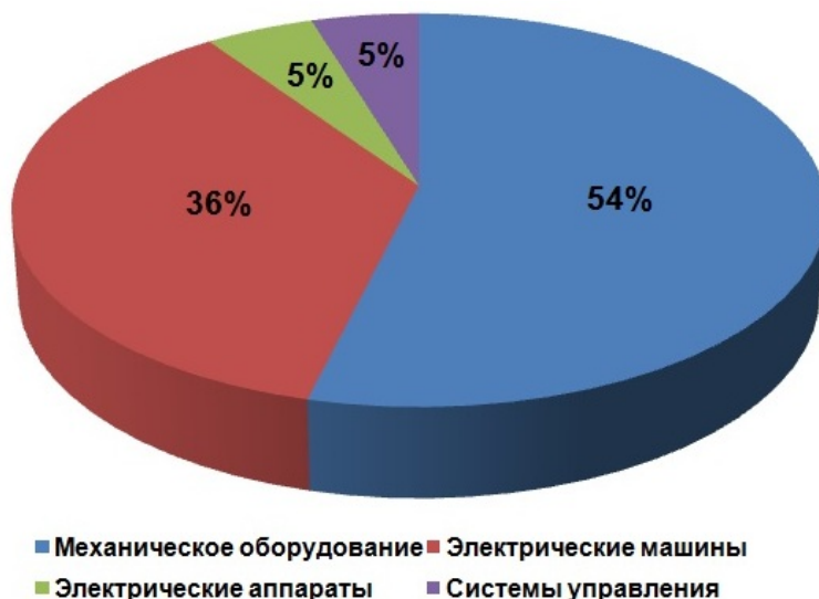
Рис. 4. Простой электровозов «O‘ZBEKISTON» на неплановом ремонте за 2011 год
