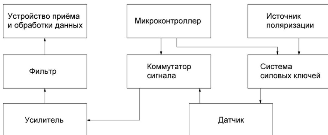
Рис. 1 – Структурная схема магнитометра
