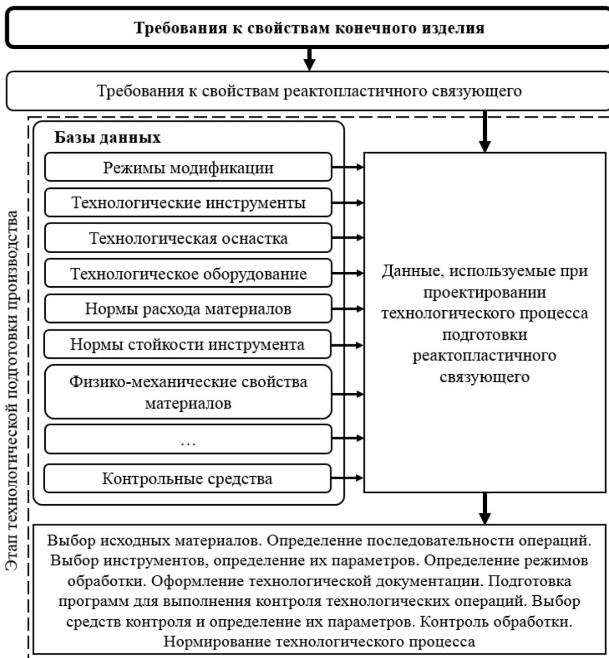
Рис. 4 – Схема информационного потока данных на этапе ТПП изделий из КМ
