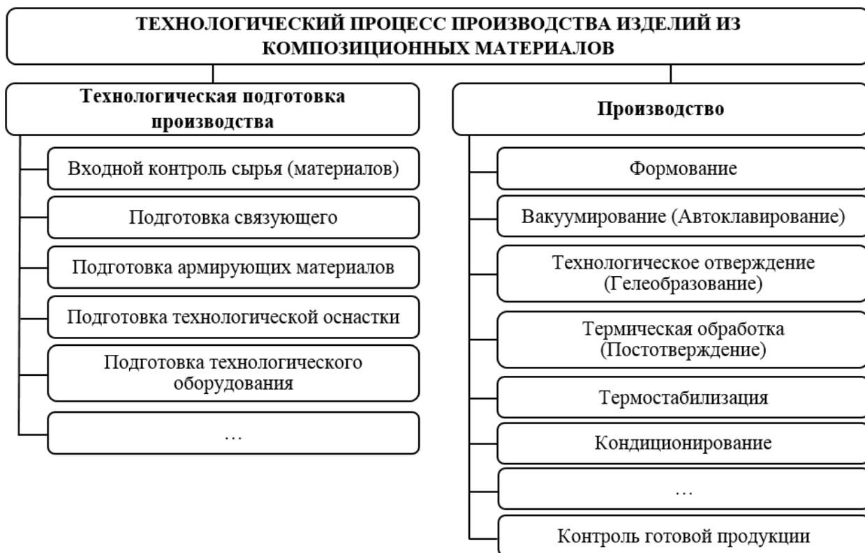
Рис. 1 – Структура технологического процесса производства изделий из КМ
