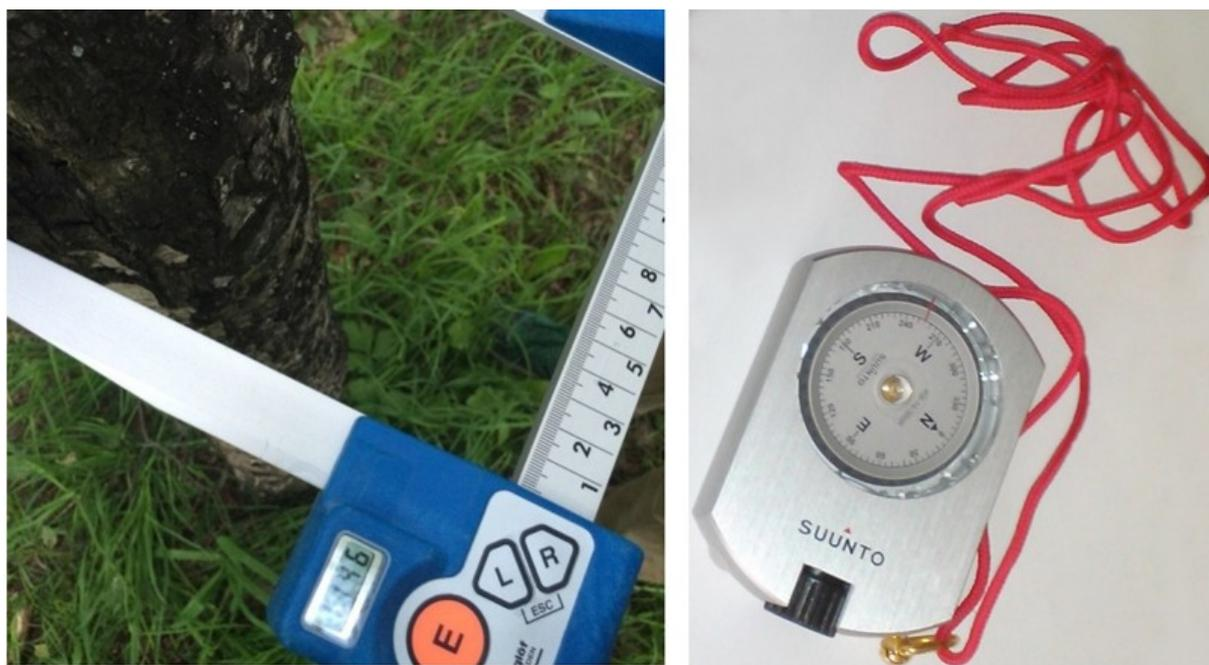
Рис.1. – Электронная мерная вилка Haglof и высотомер Suunto
