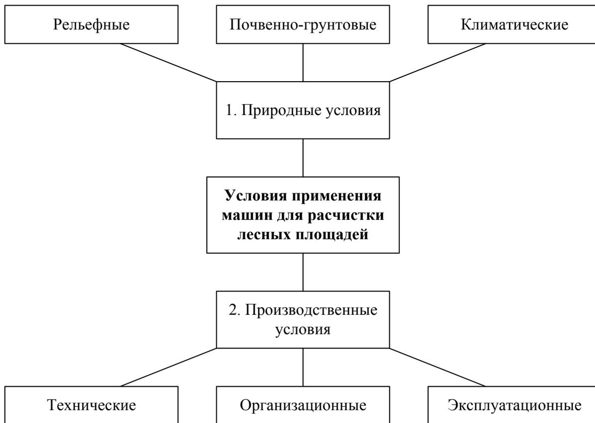
Рисунок 1. Классификация условий применения машин для расчистки лесных площадей
