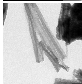
Рис. 5 Наноструктура продуктов гидратации цемента, модифицированного сахарозой (5%), (мокрый помол)
