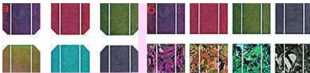
Рис. 1. Фрагменты солнечных панелей, различающихся по цветовой гамме и структуре [17]: a – монокристаллические; б – поликристаллические
