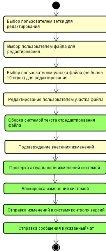
Рис. 2. – Общий ход работы прототипа приложения
