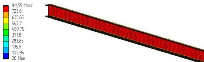
Рис. 5. – Диаграмма температуры стальной балки
