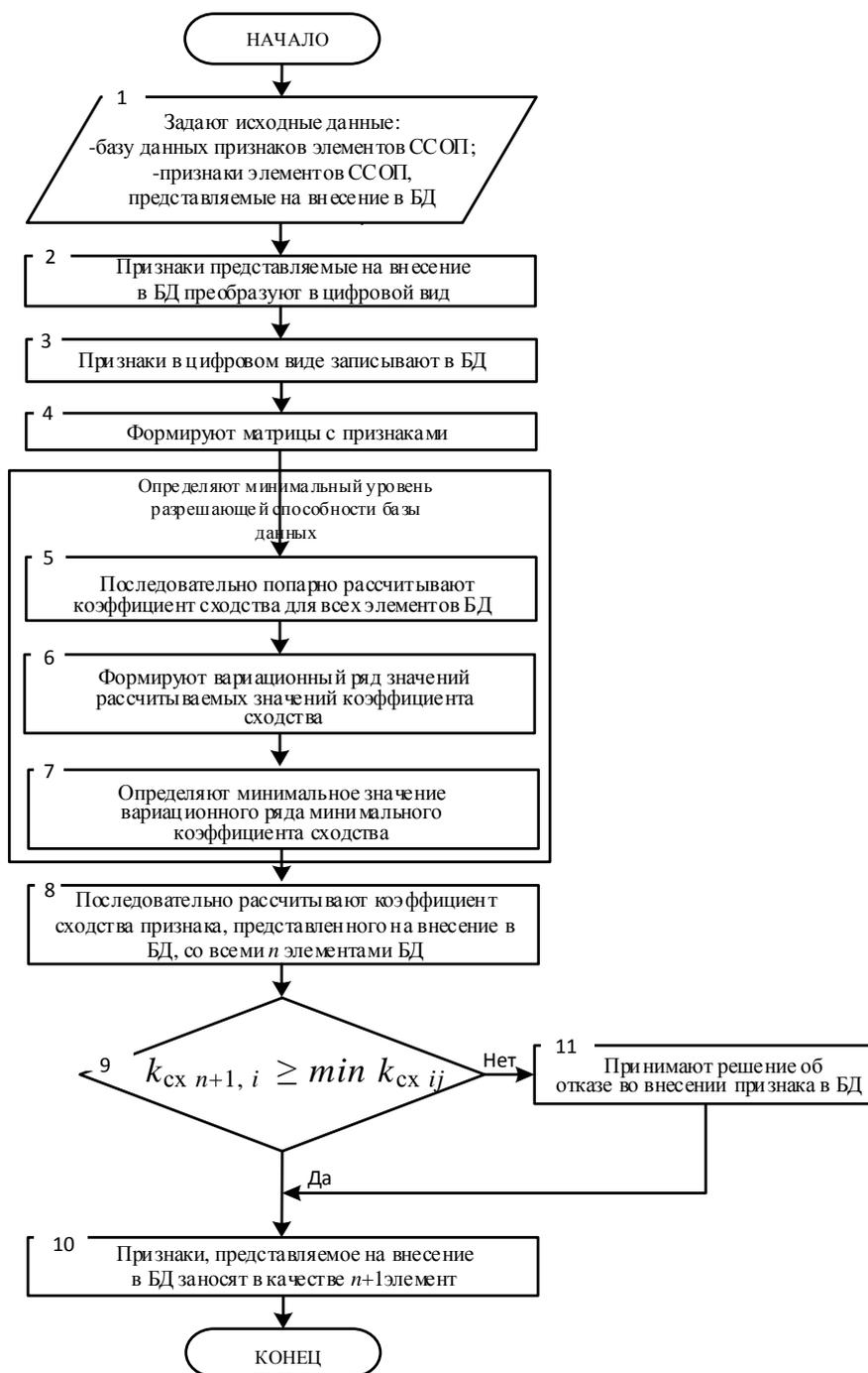
Рис. 1 – Блок-схема алгоритма методики обработки результатов мониторинга с динамически изменяемым уровнем разрешающей способности базы данных
