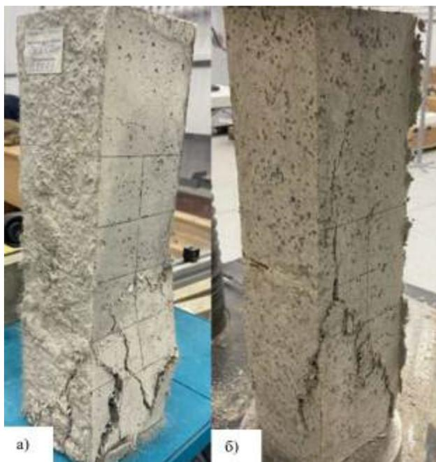
Рис. 3. Вид разрушенного полиармированного образца призмы, испытанного на сжатие
