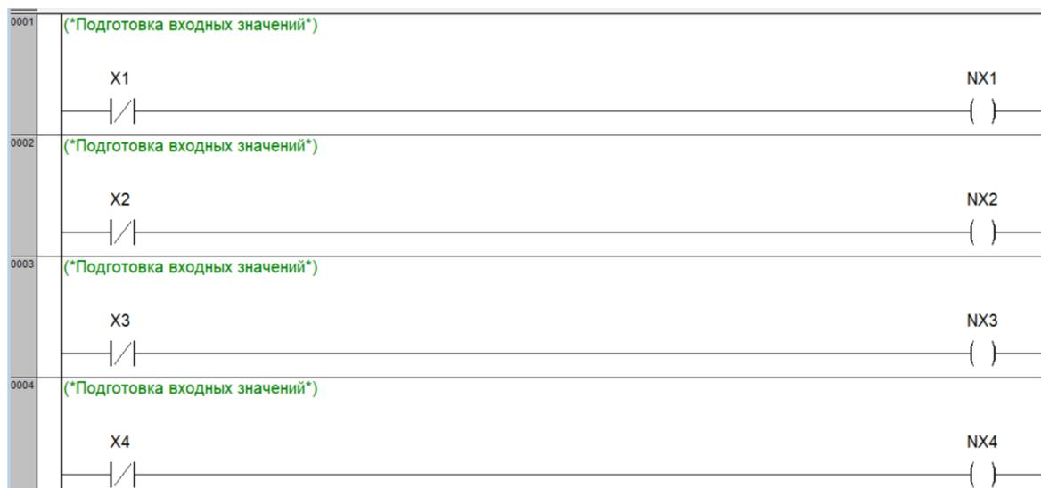
Рис. 5. – Инвертирование входных сигналов
