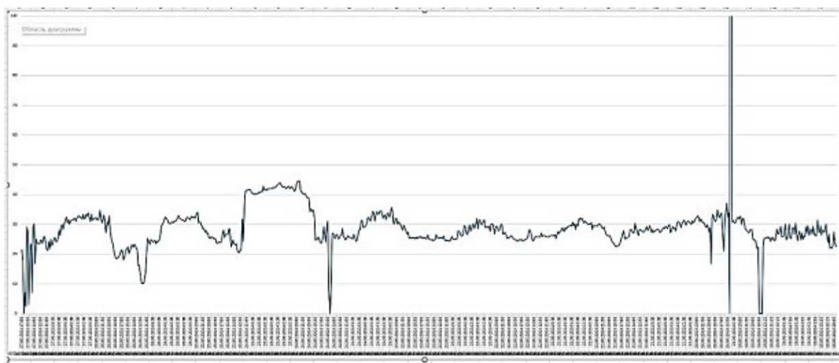
Рис. 4. – Профиль нагрузки по коэффициенту THDi фазы L1 на интервале 6 дней мониторинга электропитания на вводе в загородный дом.
