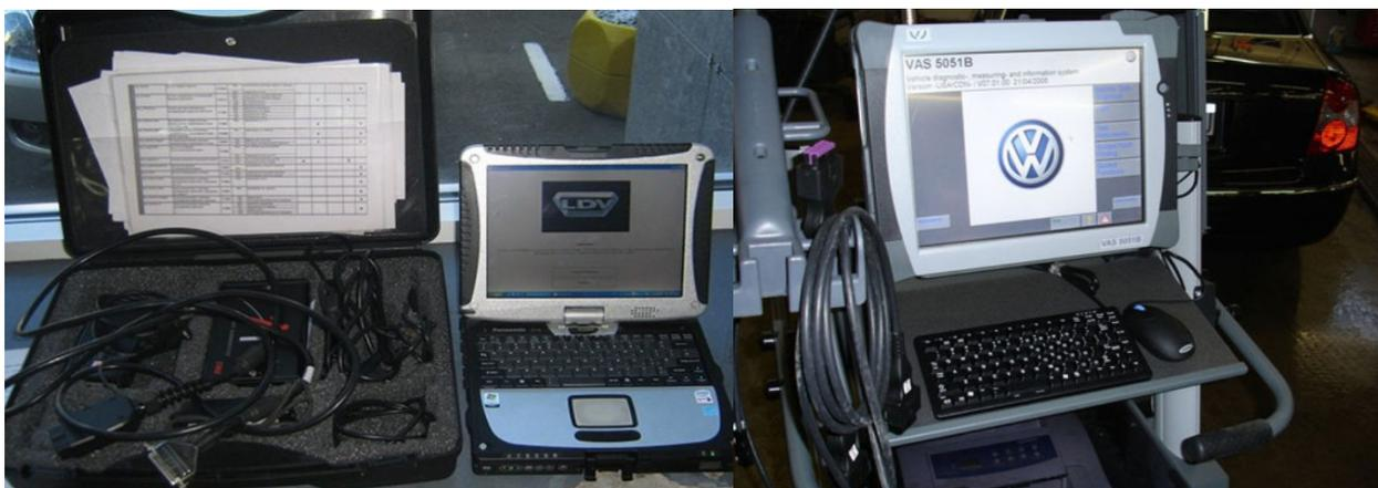
Рис. 4 - Диагностические стенды Volkswagen оборудованы современными компьютерами с фирменным программным обеспечением
