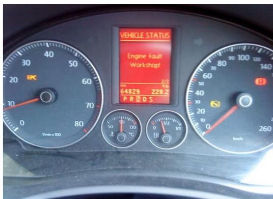
Рис.5 – Сообщение о сбое на приборной панели
