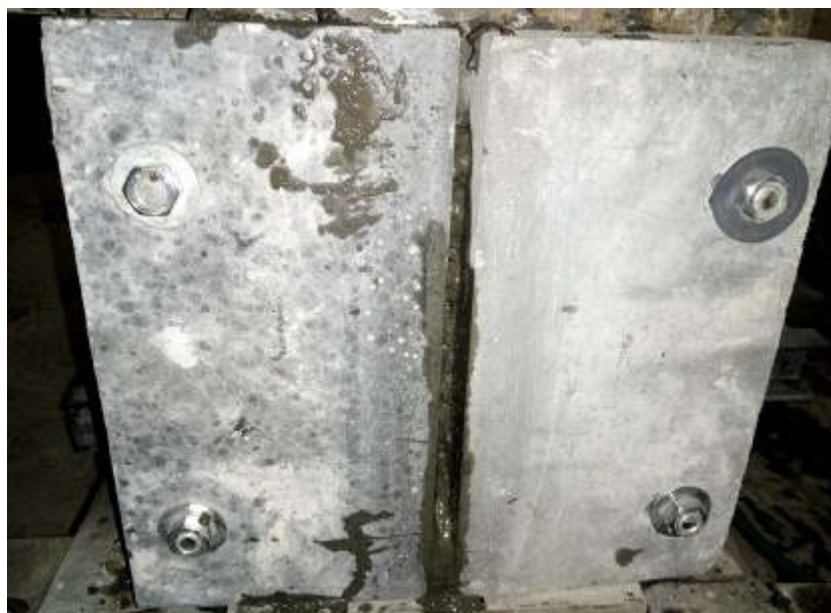
Рис. 4. – Выдавливание бетонной смеси при величине зазора 8 мм
