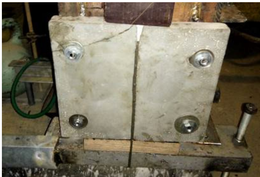
Рис. 3. – Выдавливание бетонной смеси при наличии угловых кромок
