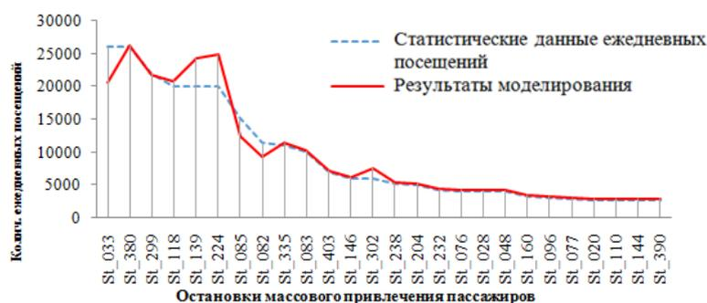
Рис. 2. – Соответствие между результатами моделирования и исходными данными
