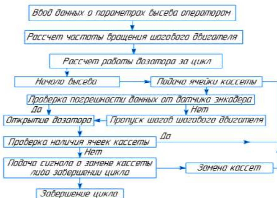
Рис. 1. – Алгоритм программного обеспечения
