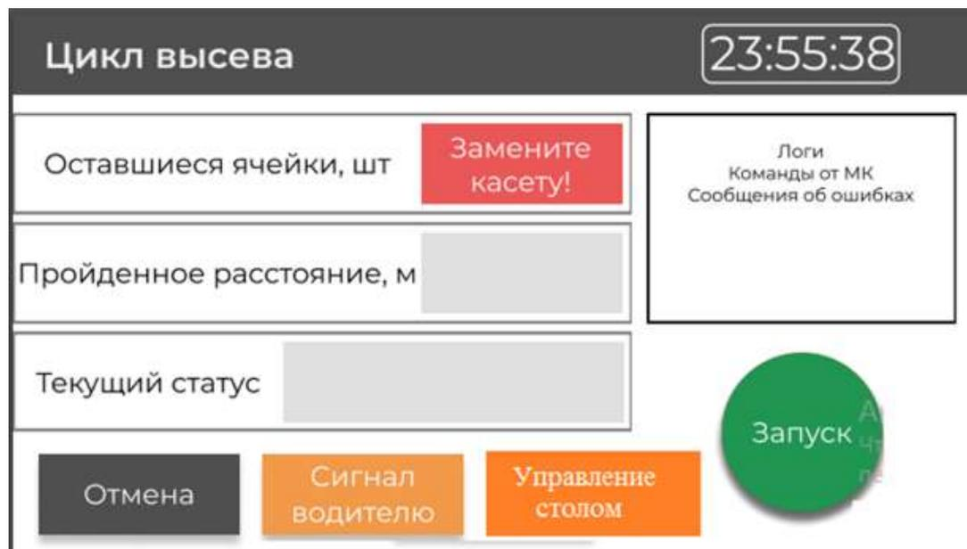
Рис. 4. – Интерфейс блока контроля исполнительных механизмов.
