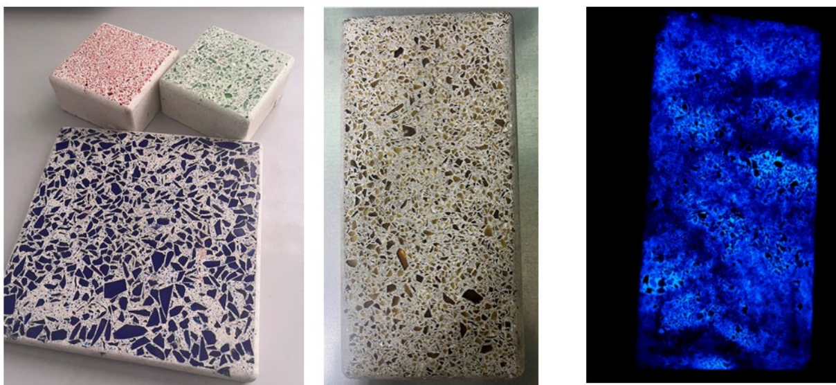
Рис. 1. – Фото опытных образцов тротуарной плитки различной формы, соответственно, при дневном свете и в темноте
