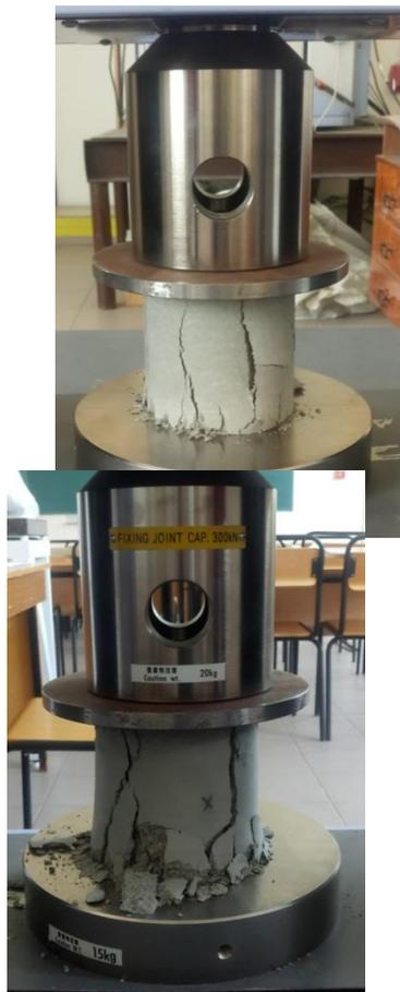
Рис. 2. Внешний вид разрушенных образцов №2 и №3
