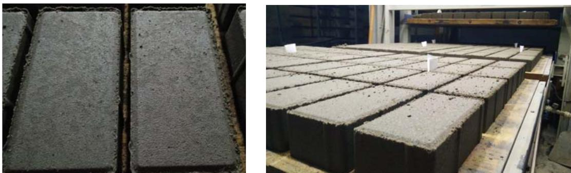
Рис. 2. Внешний осмотр тротуарной плитки («Урбан», состав № 1 табл. 10) после выхода из-под пресса
