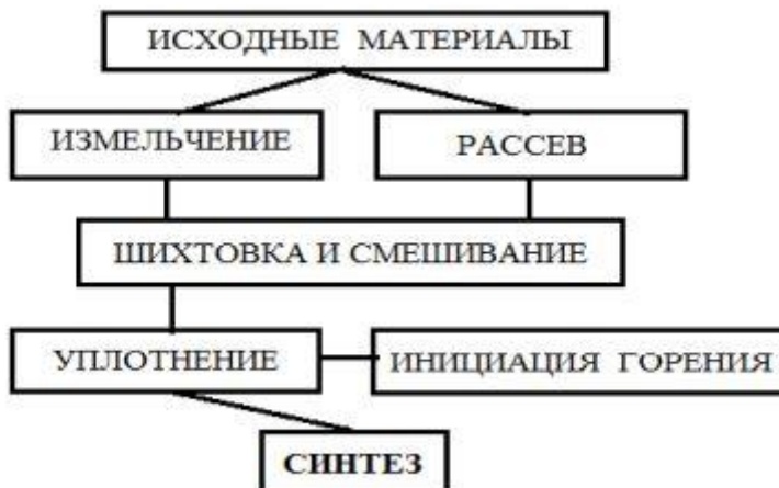
Рисунок 1 Схема технологического процесса СВС-синтеза
