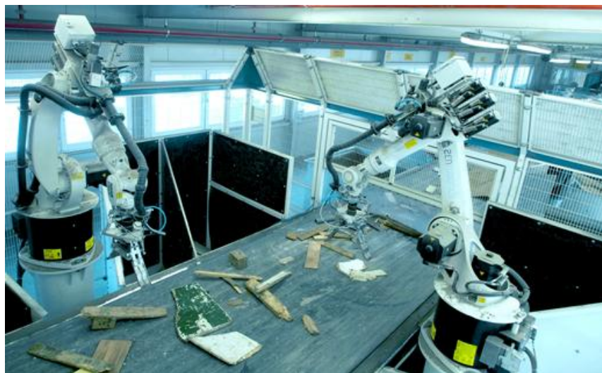
Рис.2. – Автоматическая сортировочная установка для утилизации отходов с использованием микроконтроллера
