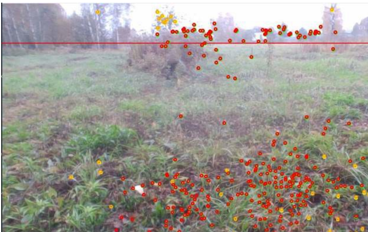
Рис. 3. – Деление поля оптического потока на две части: ниже и выше "горизонта"
