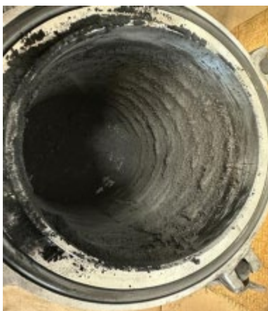
Рис. 6. – Налипание ТУ на поверхности гранулятора при работе в горизонтальном положении и скорости вращения ротора 1400 об/мин.
