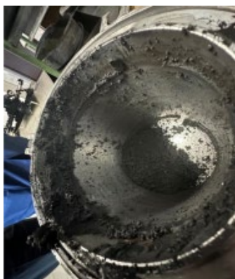
Рис. 5. – Налипание ТУ в застойной зоне гранулятора при реализации методики 3.
