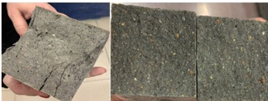
Рис. 4. – Характер разрушения образцов (авторское изображение)
