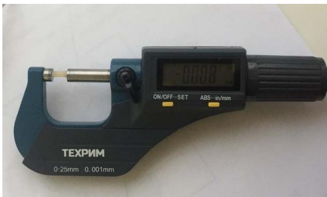
Рис. 3. – Микрометр электронный «ТЕХРИМ»
