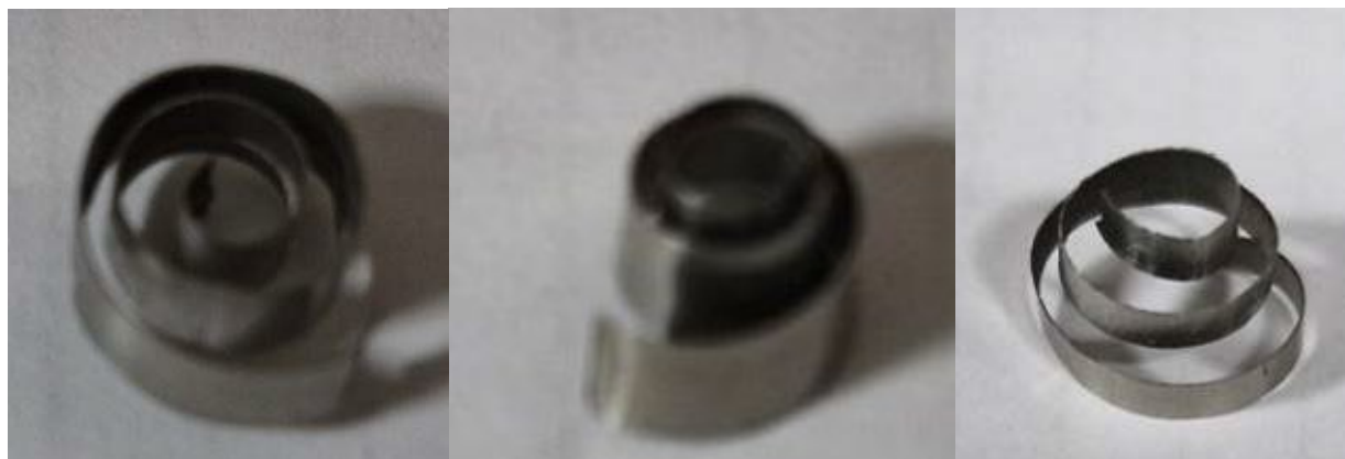
Рисунок 5 - Фотографии стружки при порезке заготовок при подаче на зуб 0,07мм.
