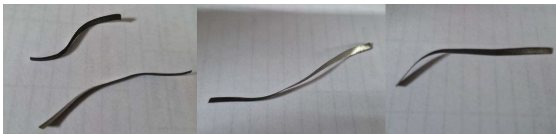
Рисунок 7 - Фотографии стружки при резке заготовок с подачей на зуб 0,06мм.
