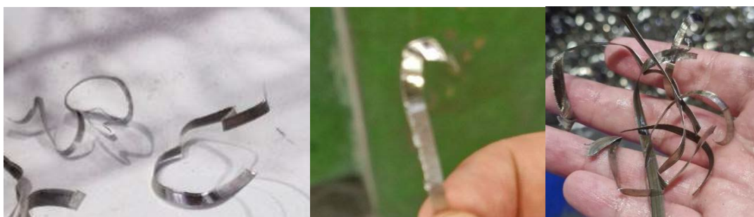
Рисунок 8 - Фотографии стружки, попавшей в зону резания при резке заготовок при подаче на зуб 0,06мм.
