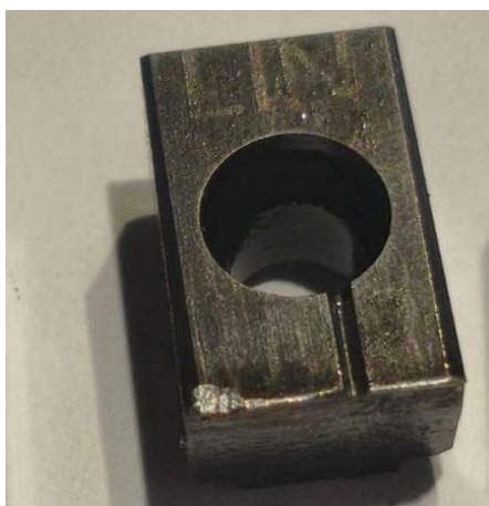
Рисунок 6 - Фотографии износа твёрдосплавных пластин при порезке заготовок при подаче на зуб 0,07мм.
