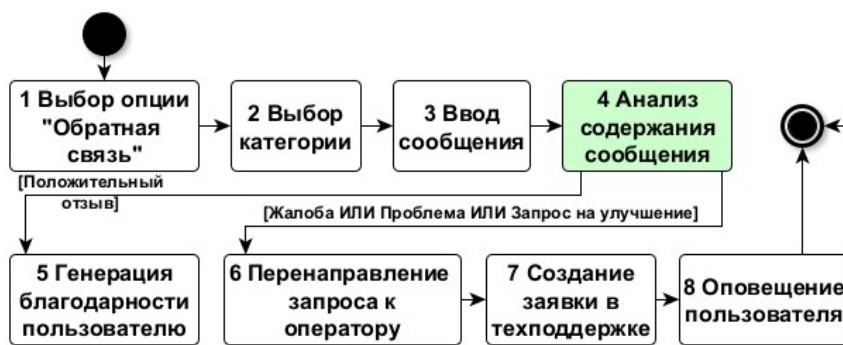
Рис. 3. – Диаграмма состояний UML варианта использования «Обратная связь»
