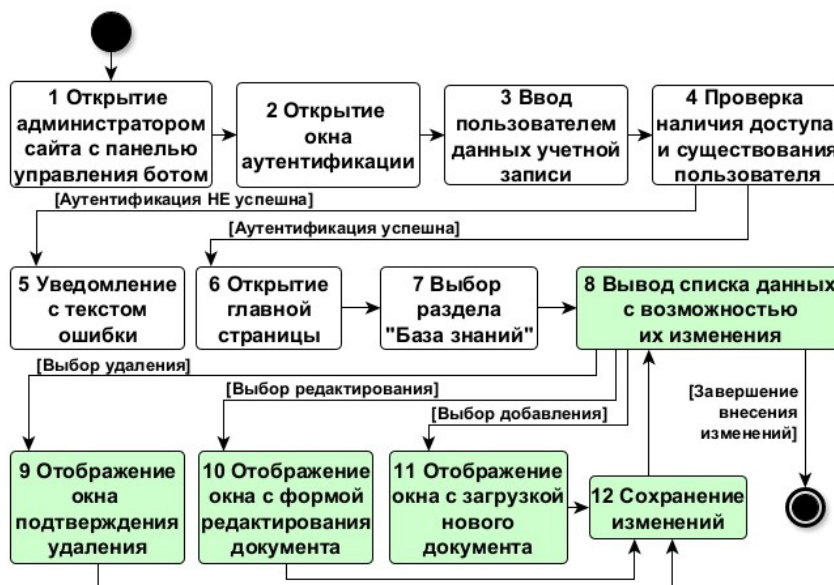
Рис. 4. – Диаграмма состояний UML варианта использования «Управление базой знаний»
