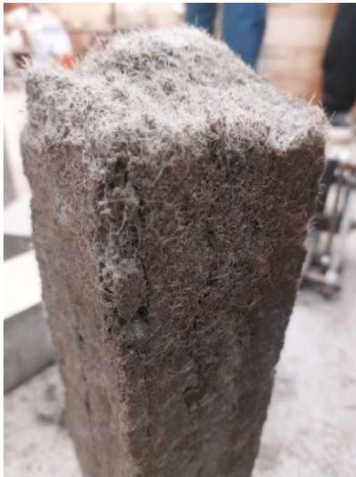
Рис. 6. – Общий вид разрушенных образцов призмы на растяжение. с 2,5% содержанием фибры
