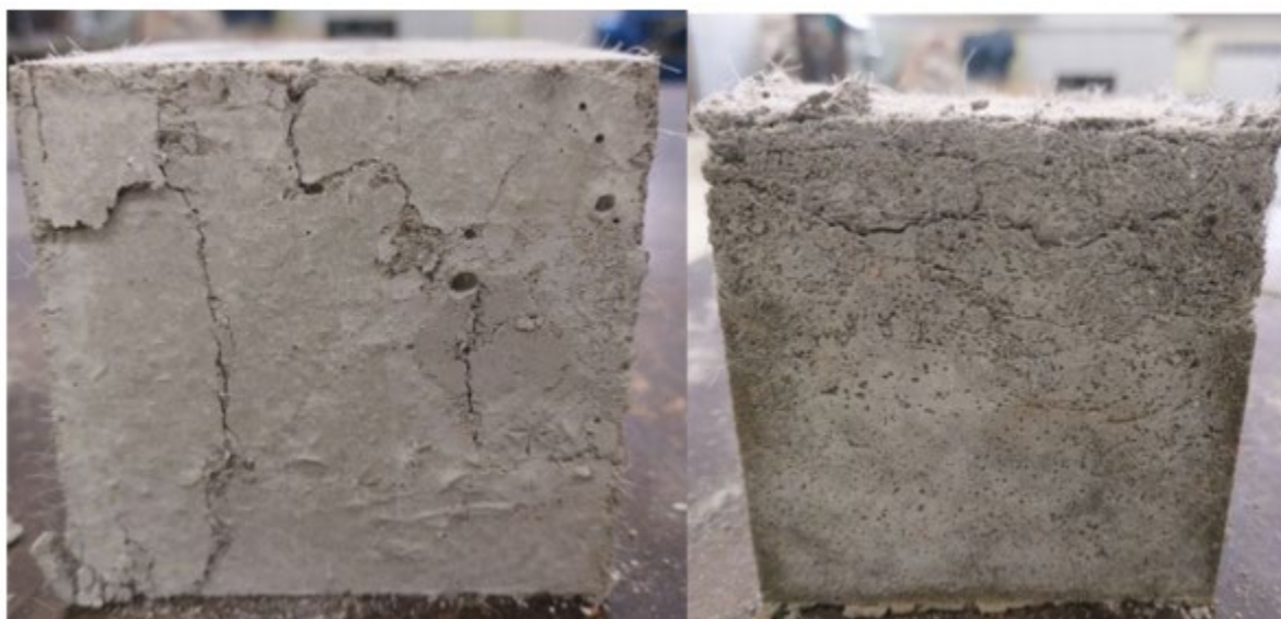
Рис. 4. – Общий вид разрушенных образцов кубов слева \mu_f = 1\% фибры; справа \mu_f = 2,5\% фибры
