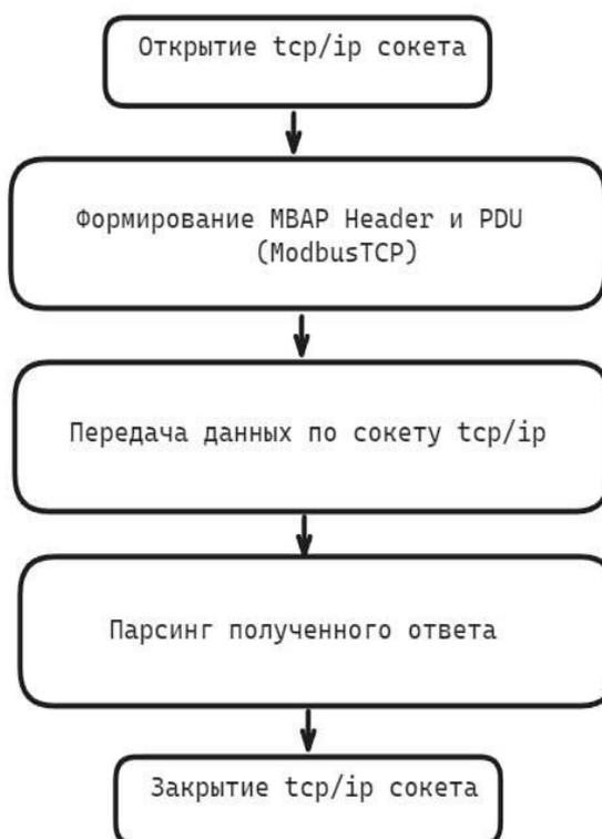
Рис. 5. Блок-схема с алгоритмом работы
