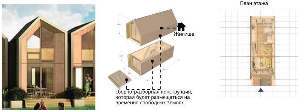
Рис. 2. — Фото, изометрия, план и разрез проекта Heijmans ONE. [12].
