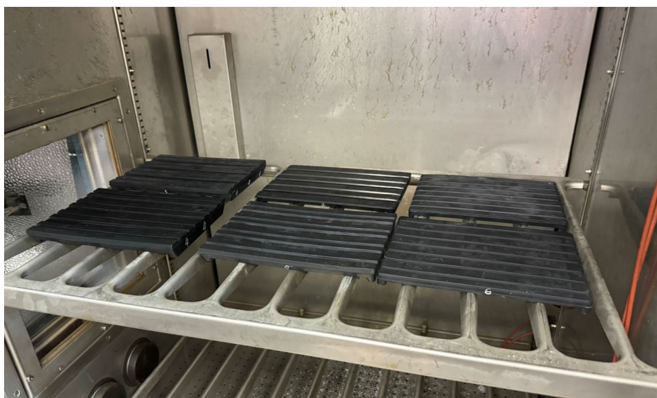
Рис. 1. – Климатическая камера с образцами для испытаний
