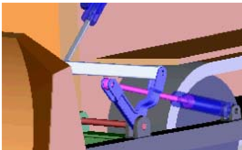
Рис. 4 Виртуальная модель предлагаемой конструкции управления отвалом
