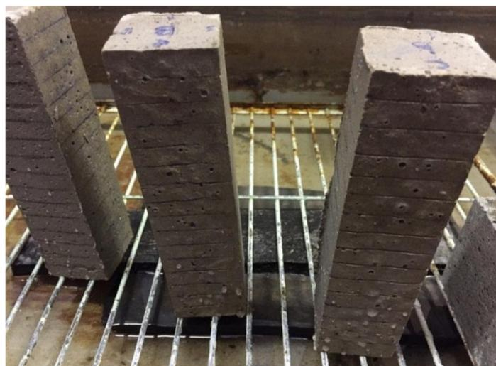
Рис. 3. – Образцы в ванной с гидравлическим затвором
