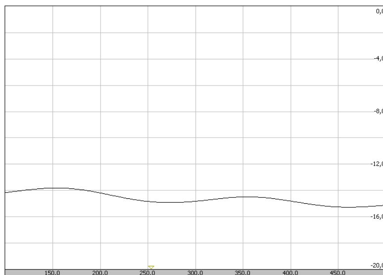
Рис. 6. – Переходное ослабление направленного ответвителя
