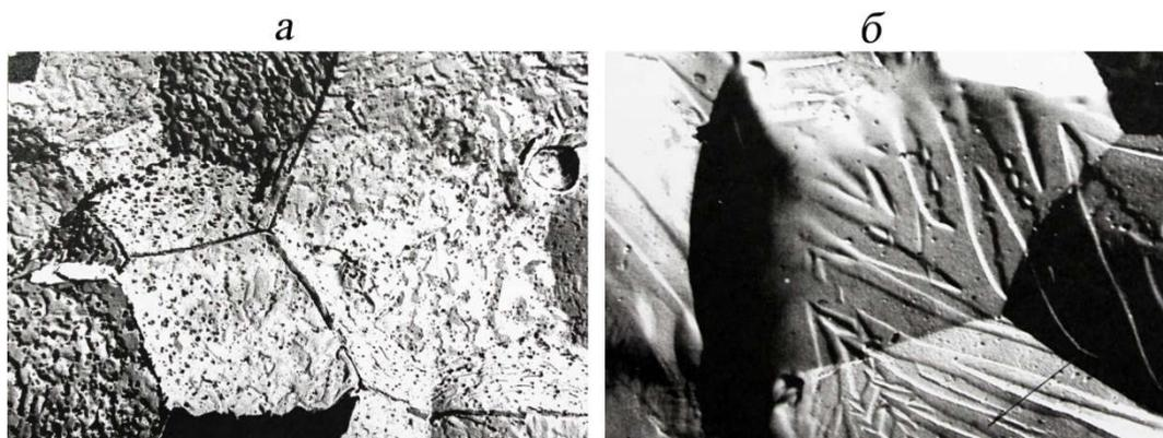
Рис. 1. – Микрофотографии неполяризованной (а) и поляризованной (б) керамики при увеличении  $\times 1400$  (а) и  $\times 1350$  (б)
